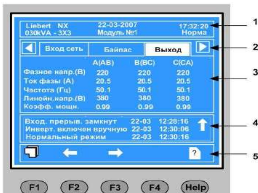
Рис. 4. Графические окна ЖК-дисплея и клавиши навигации по меню 1 – окно системных параметров; 2 – окно меню; 3 – окно данных; 4 – окно текущих записей; 5 – окно функций клавиш меню.
