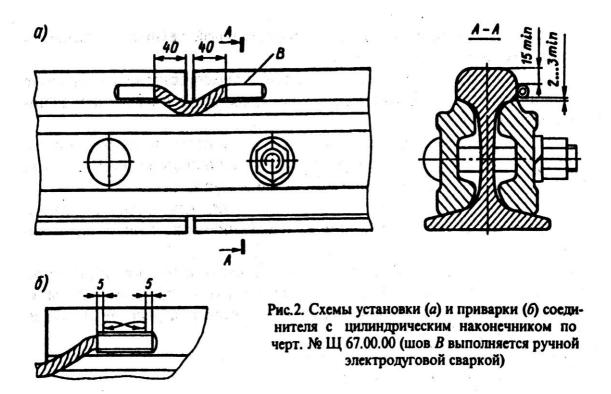
Приварку соединителей с цилиндрическими манжетами производят аналогично приварке соединителей фартучного типа, только не доводя шов до обоих концов наконечника на расстояние 5 мм с целью исключения попадания меди в шов и повреждения торцевого прикрепления (рис.2, б).
