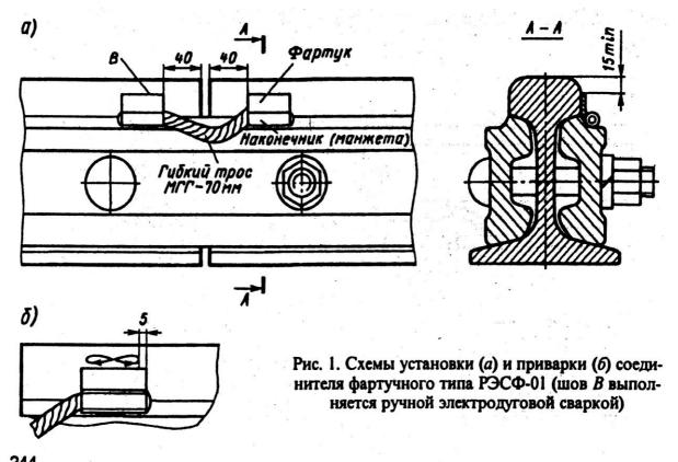
(см. рис. 1,б) следует начинать с середины фартука в сторону стыкового зазора рельсов после чего, не прерывая дуги, необходимо произвести наложение отжигающего валика по первому шву до середины манжеты. Затем следует приварить вторую половину манжеты и, не доходя 5мм до конца, не прерывая дуги выполнить наложение отжигающего валика снова в середине манжеты.
