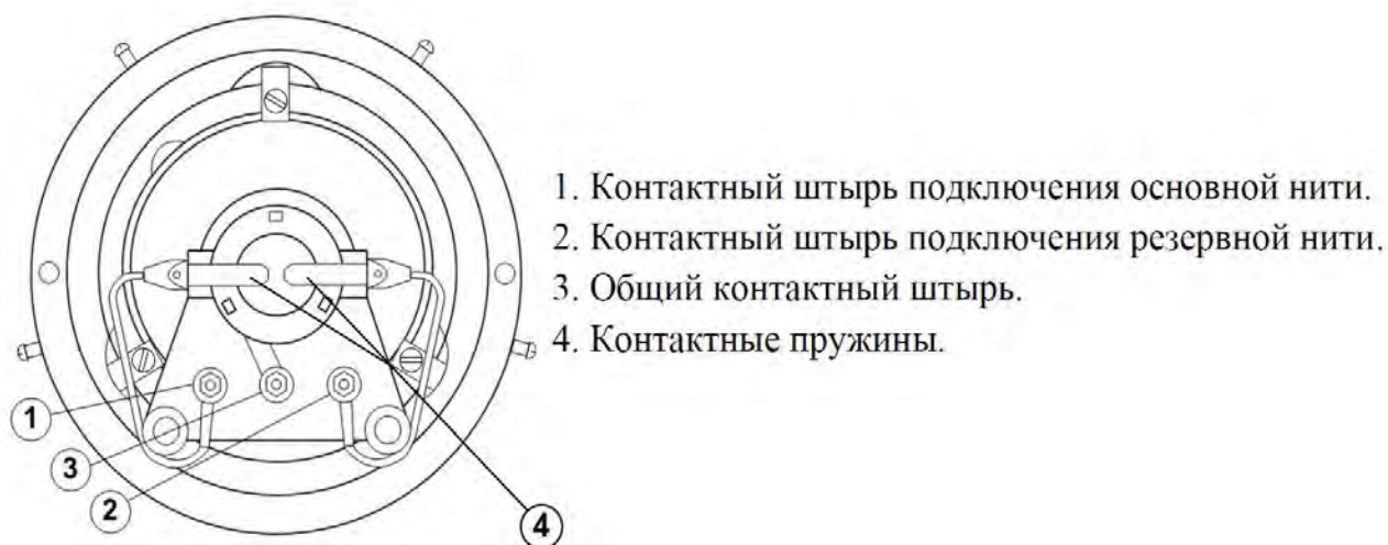
Рис.1. Линзовый комплект с двухнитевой лампой
