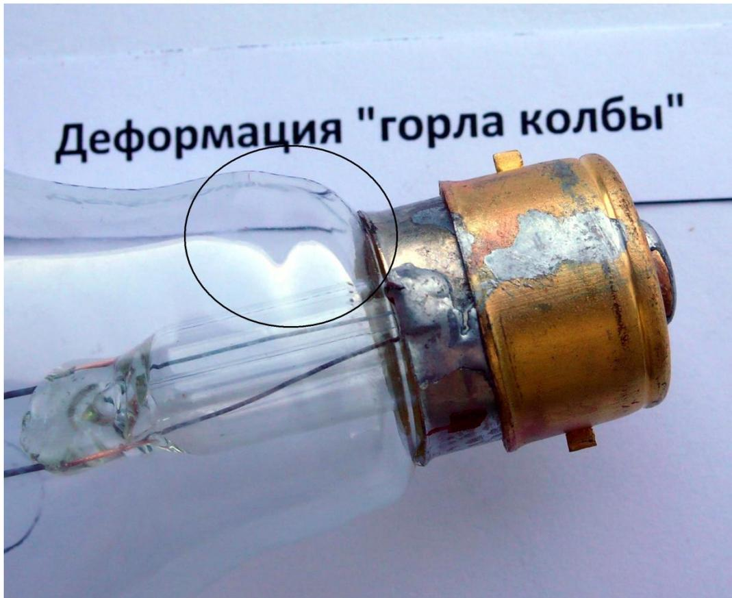
Рис.8 Деформация горла колбы
