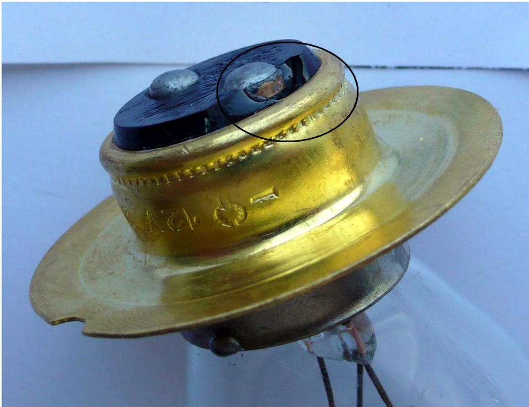
Рис.15 Разрушение изоляционного стекла
