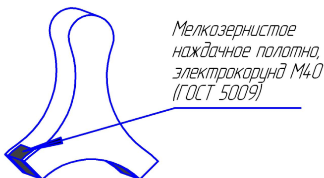
Рис. 21. Колодка для шлифовки коллектора
