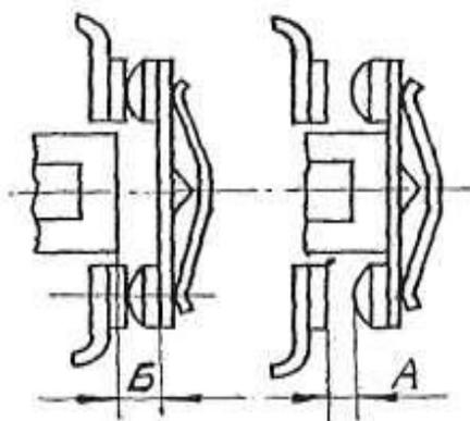
Рис. 1 Схема измерения раствора (расстояние А) и провала (расстояние Б) главных контактов контакторов и магнитных пускателей
