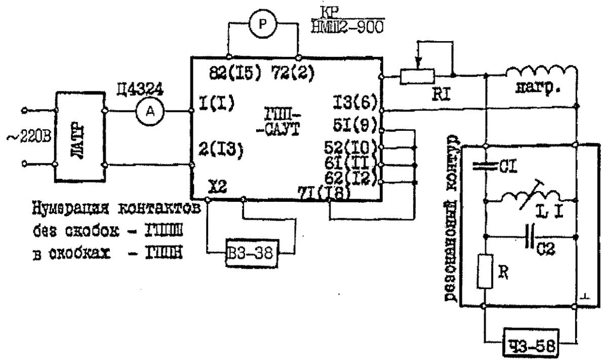
Рисунок Б.3 – Схема проверки электрических характеристик программируемого путевого генератора.
