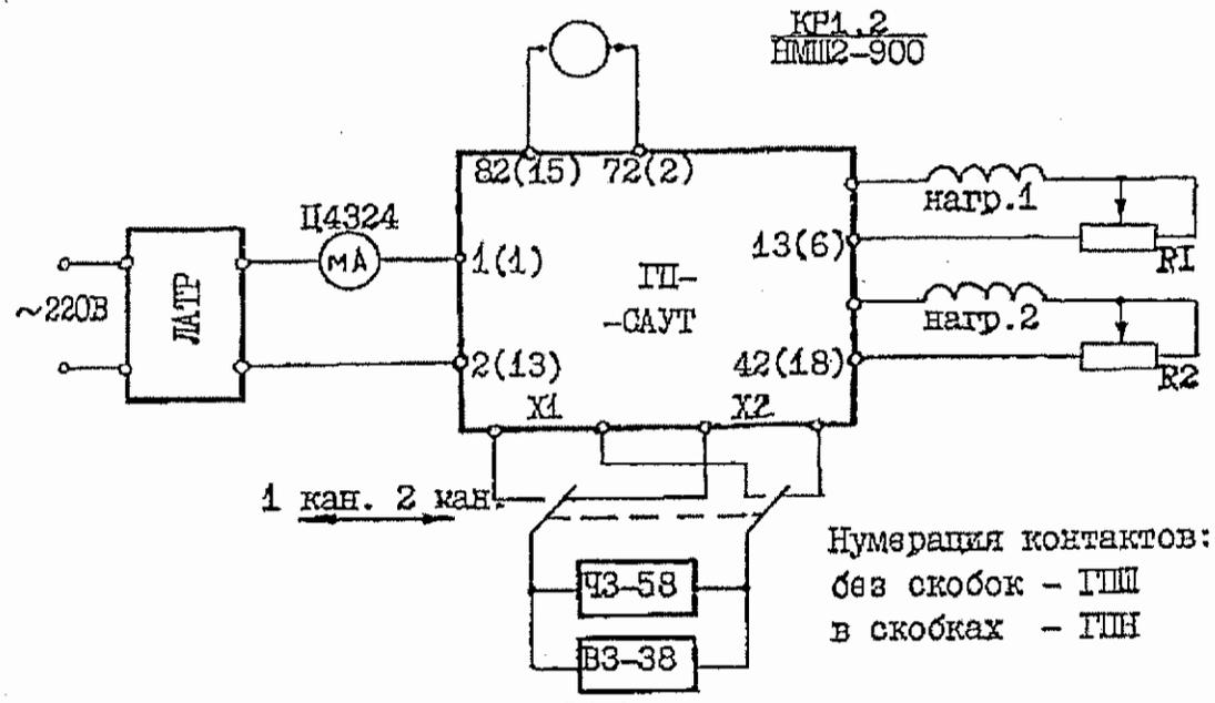
Рисунок Б.1 – Схема проверки электрических характеристик непрограммируемого путевого генератора.
