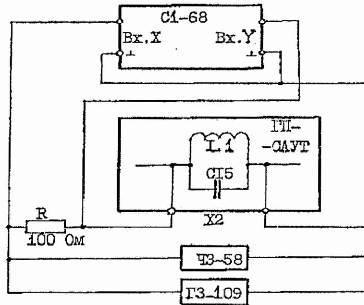
Рисунок Б.2 – Схема проверки фильтра-пробки непрограммируемого путевого генератора
