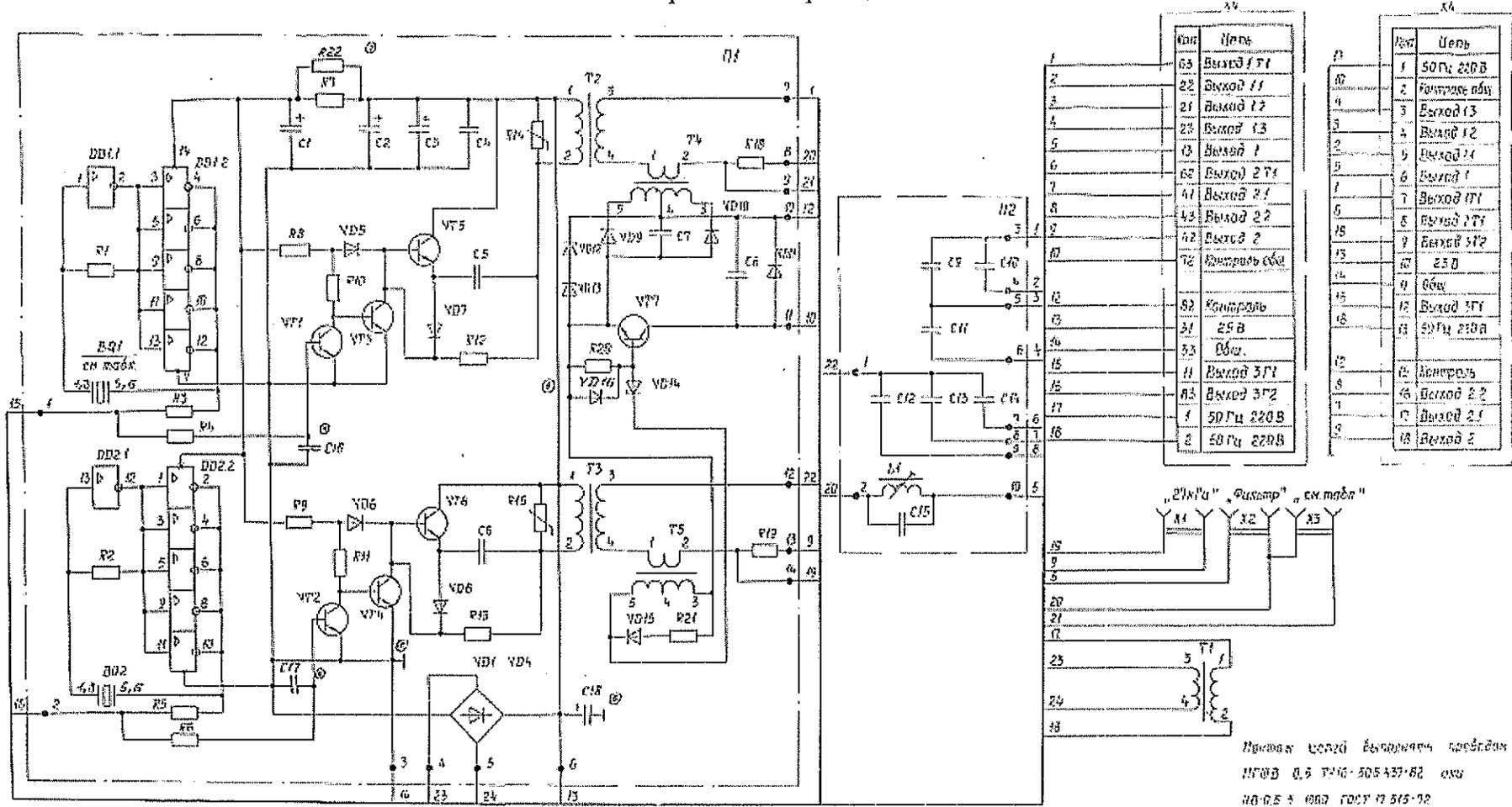
Рисунок В.1 – Схема электрическая принципиальная непрограммируемого ГП САУТ.
