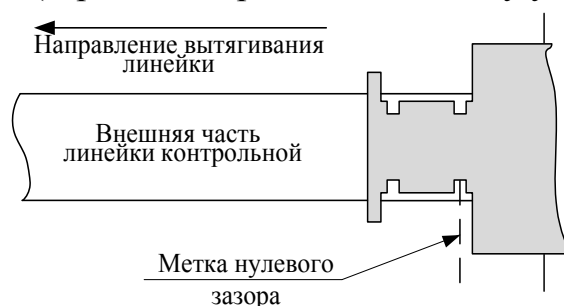
Рис.9. Схема нулевой отметки на контрольной линейке по Т-образной планке с соблюдением размера «А» (сердечник прижат к дальнему усовику)
