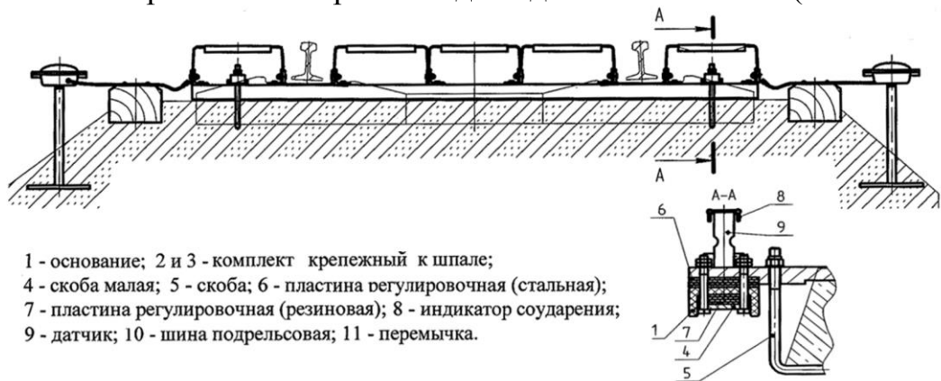
Рис. 8. Устройство контроля схода подвижного состава (УКСПС-У-1)
