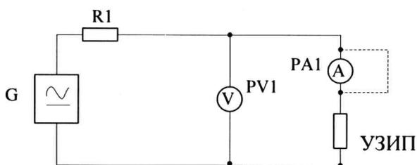
Рисунок А.2. Схема проверки электрических параметров UBK-2-500
