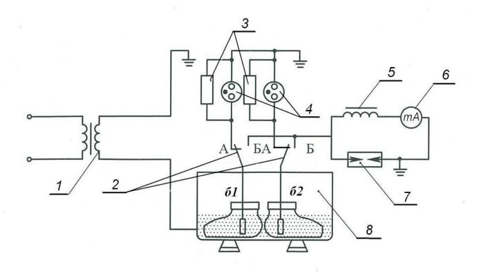
Рисунок 1 – Принципиальная схема испытания диэлектрических бот
