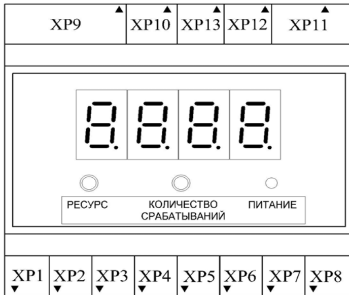
Рисунок А.1 - Внешний вид и расположение органов индикации модуля регистрации в ШРУ-3.
