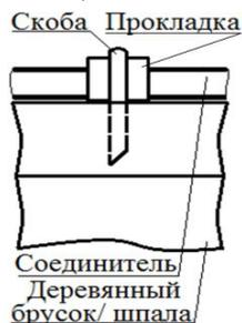
Рис.2. Крепление соединителя к деревянному бруску/шпале
