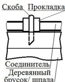
Рис.1. Крепление соединителя к деревянному бруску/шпале
