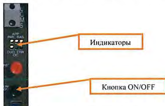
Рисунок 18. Отключение платы COM5.
