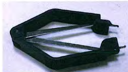
Рисунок 12. Извлечение микросхемы ПЗУ и вид экстрактора.
