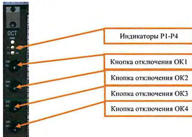
Рисунок 31. Отключение питания платы SRC.
