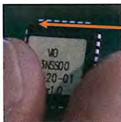
Рисунок 13. Внешний вид микросхемы ПЗУ.
