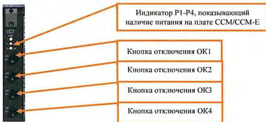
Рисунок 8. Отключение питания платы ССМ/ССМ-Е.
