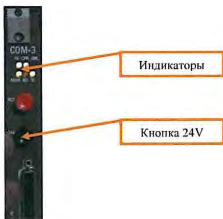
Рисунок 15. Отключение питания на плате COM3.
