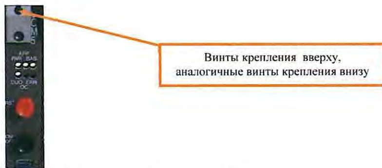
Рисунок 20. Крепление платы COM5.
