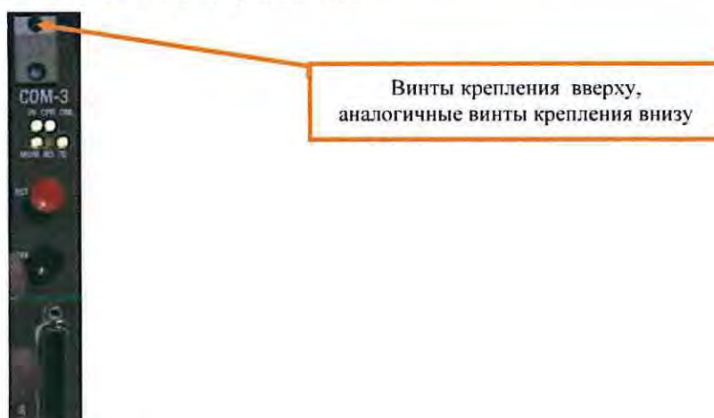
Рисунок 16. Крепление платы COM3.
