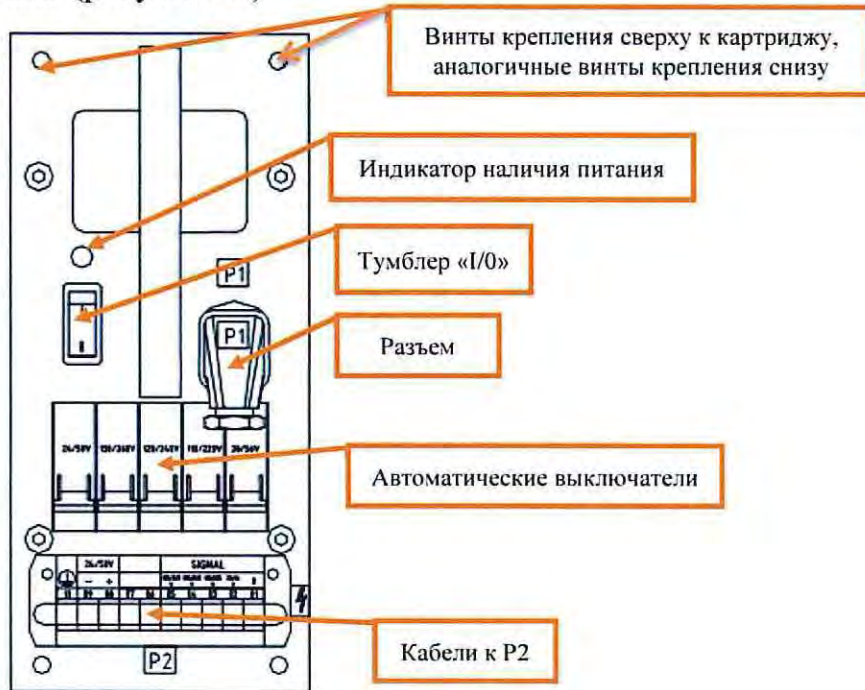
Рисунок 20. Отключение питания и крепление на PSU-330.
