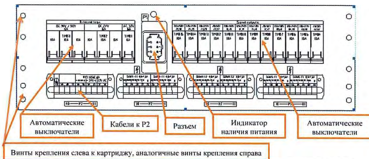
Рисунок 18. Отключаемые элементы от источника питания PSU-161.
