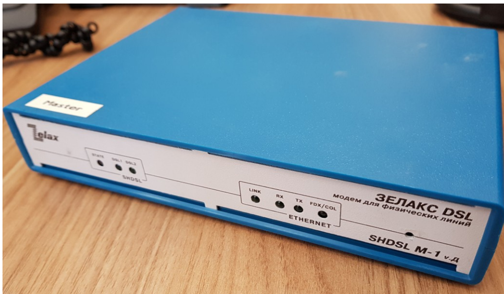
Рисунок 1. Внешний вид модема Zelax M1.
