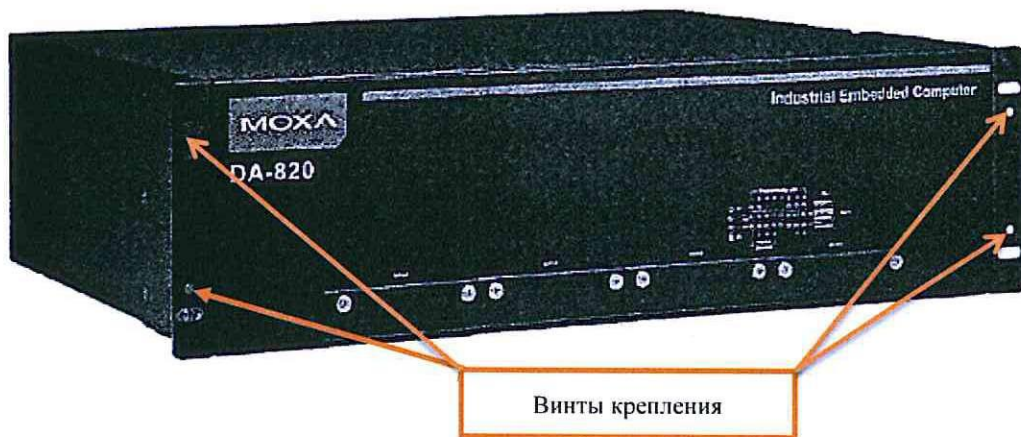
Рисунок 4. Винты крепления компьютеров А (С).
