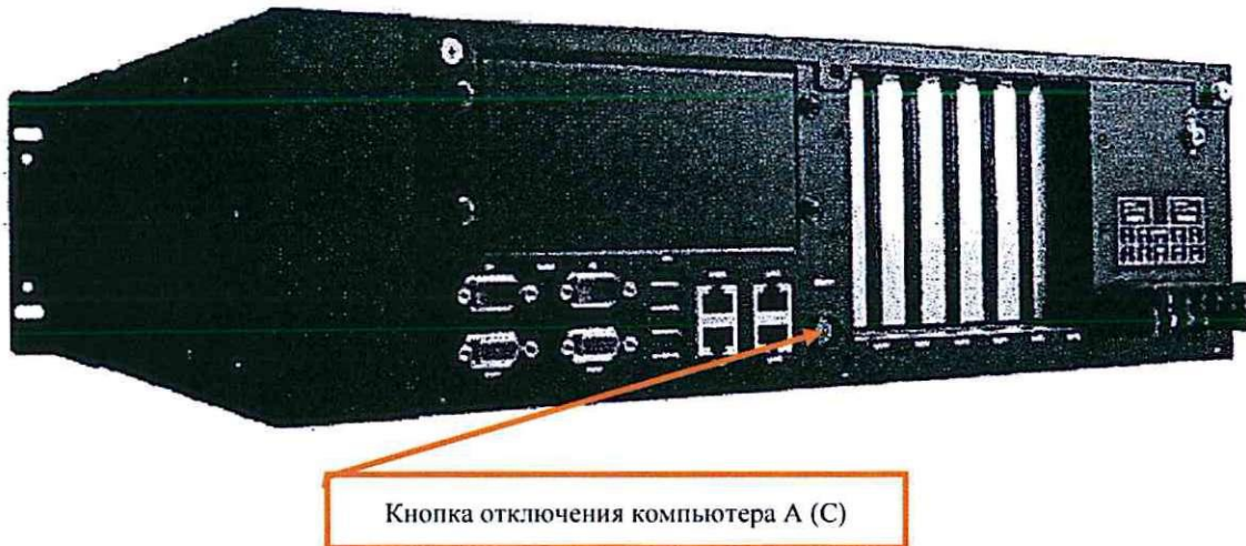
Рисунок 2. Отключение компьютера А (С).
