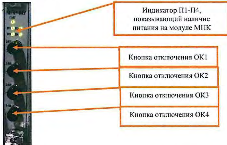
Рисунок 9. Отключение питания модуля МПК.
