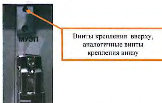
Рисунок 31. Крепление модуля МУЭП.
