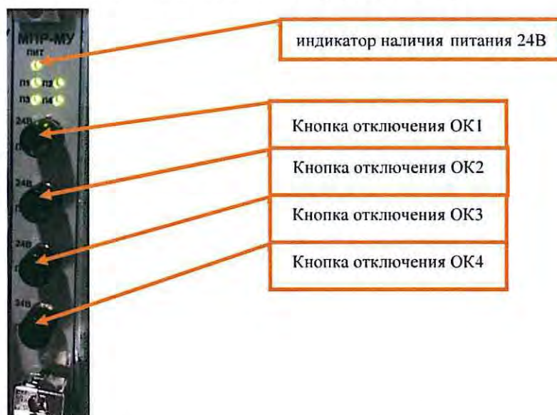
Рисунок 3. Отключение объектных контроллеров.
