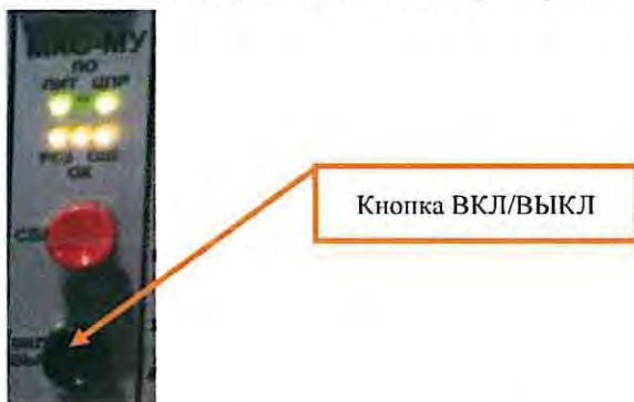
Рисунок 17. Отключение модуля МКС-МУ.
