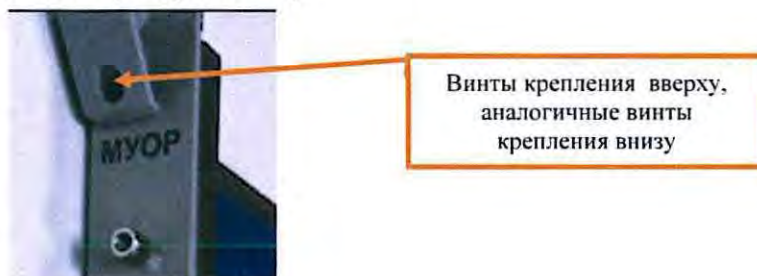
Рисунок 39. Крепление модуля МУОР.
