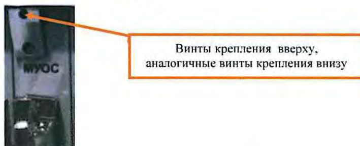
Рисунок 25. Крепление модуля МУОС.
