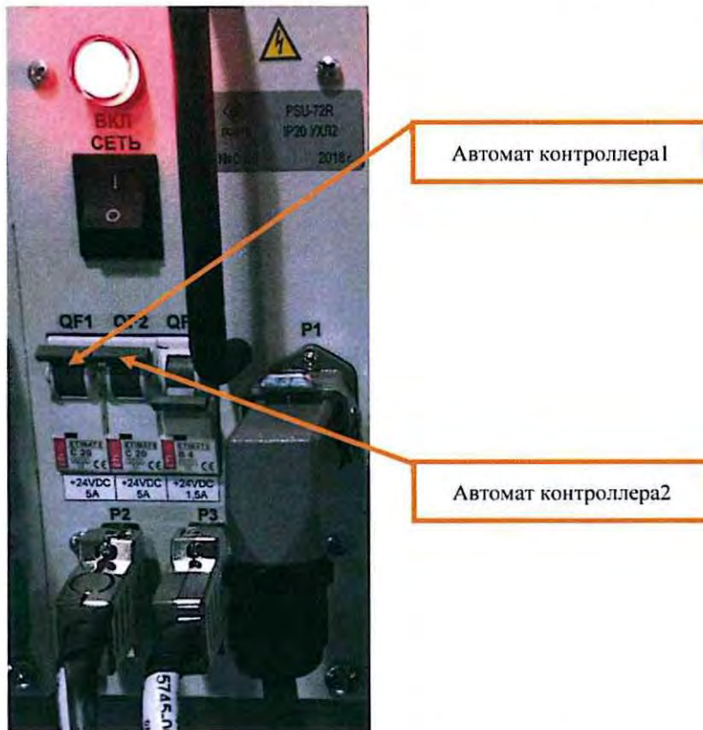
Рисунок 4. Отключение источника питания.
