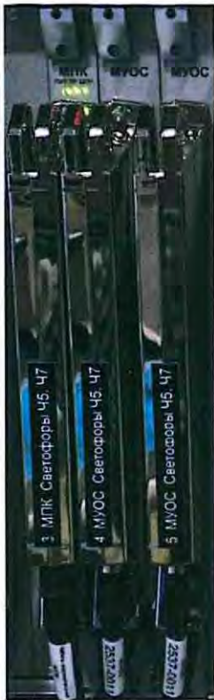
Рисунок 21. Внешний вид модуля МУОС.
