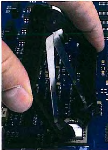
Рисунок 13. Извлечение микросхемы ПЗУ и вид экстрактора.
