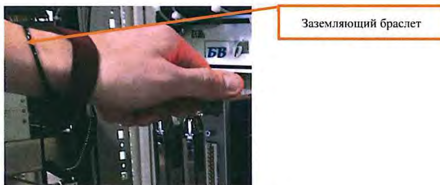
Рисунок 26. Изъятие модуля МУОС.
