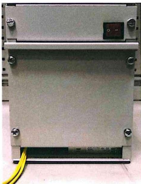
Рисунок 10. Внешний вид системного блока АРМ ДСП.
