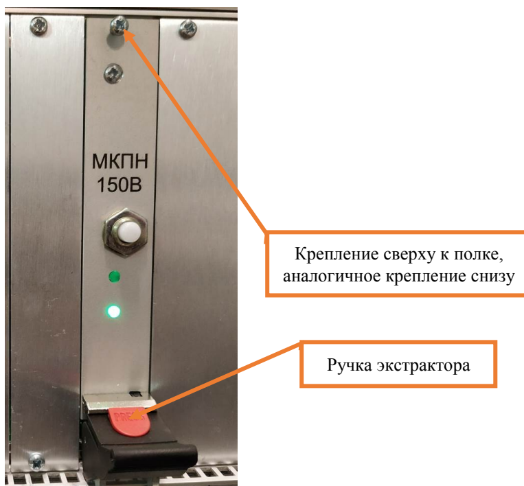
Рисунок 33. Крепление и ручка экстрактора модуля МКПН.
