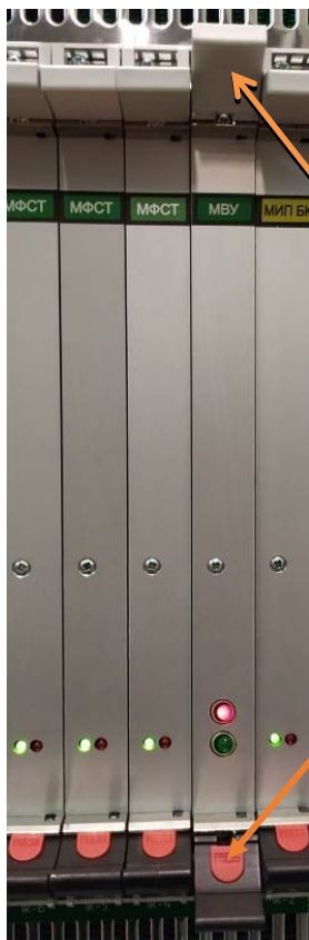
Рисунок 16. Извлечение модуля МВУ.
