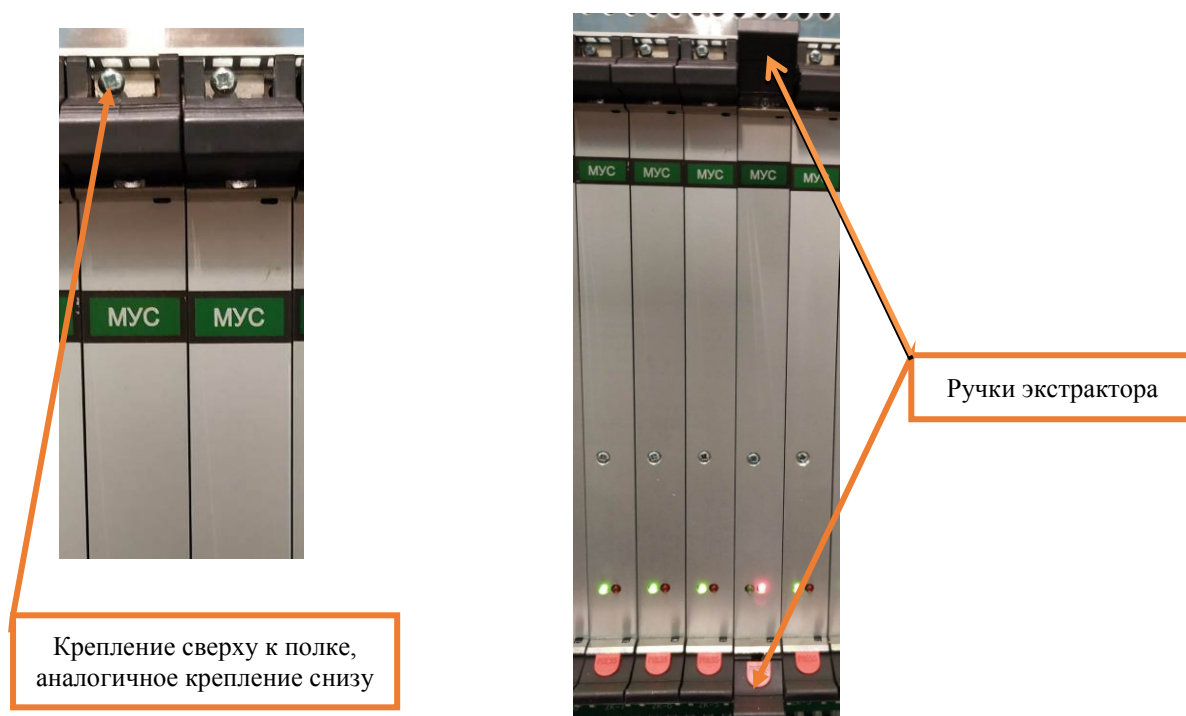
Рисунок 31. Крепление и ручки экстрактора модуля МУС.
