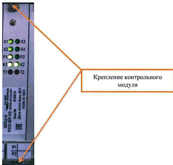
Рисунок 4. Крепление контрольного модуля.
