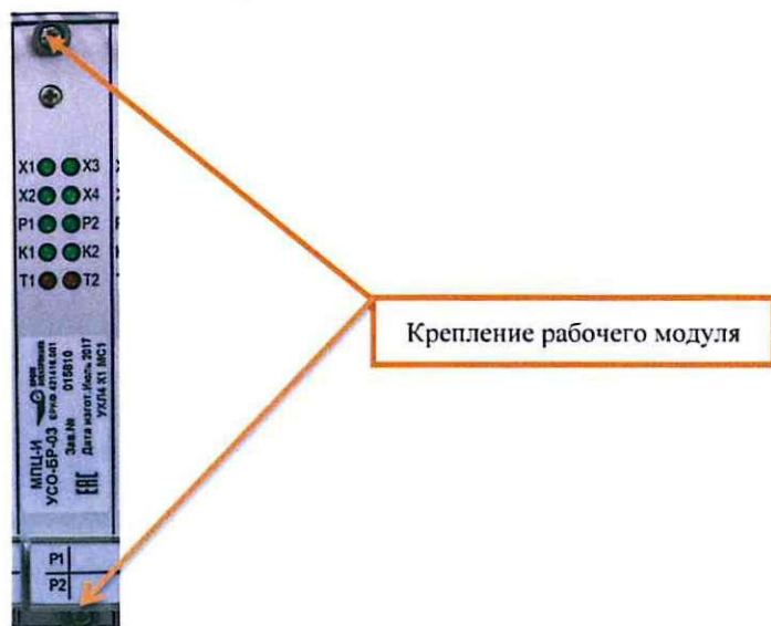
Рисунок 6. Крепление рабочего модуля.
