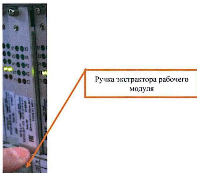
Рисунок 7. Ручка экстрактора рабочего модуля.
