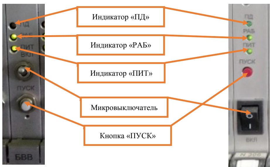
Рисунок 5. Включение блока БВВ.
