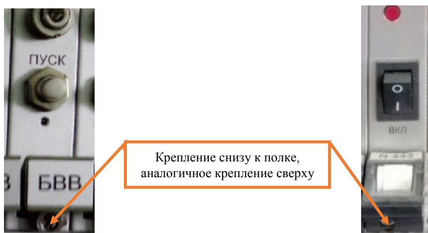
Рисунок 3. Крепление блока БВВ.
