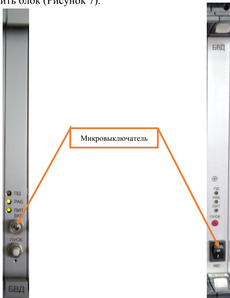
Рисунок 7. Микровыключатель на блоке БВД.
