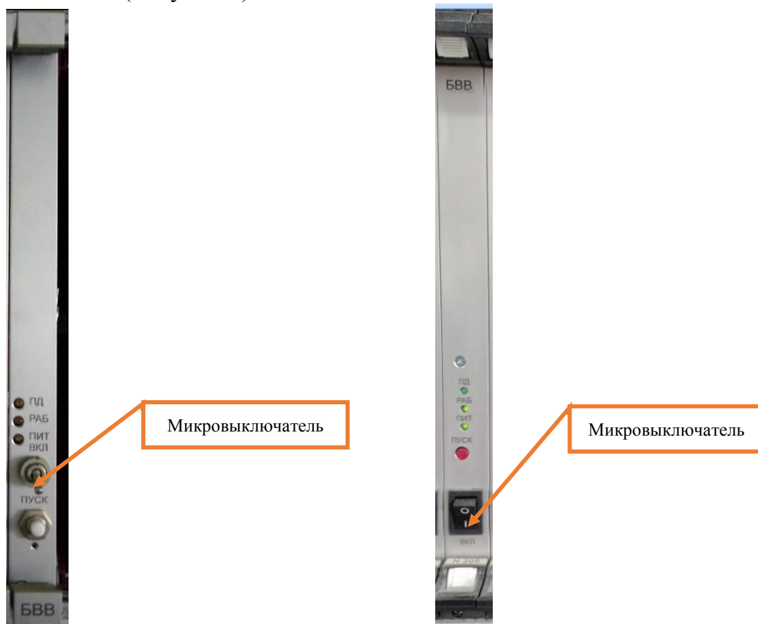
Рисунок 2. Микровыключатель на блоке БВВ.
