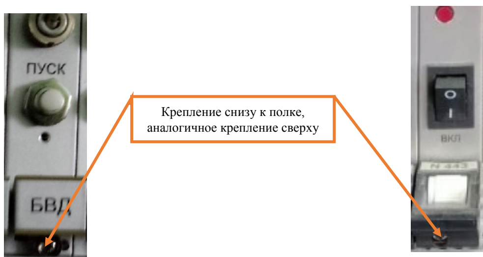
Рисунок 8. Крепление блока БВД.
