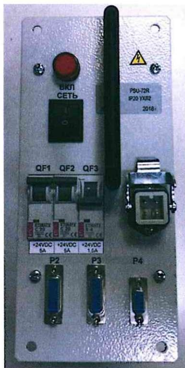
Рисунок 1. Внешний вид источника питания PSU-72 R.
