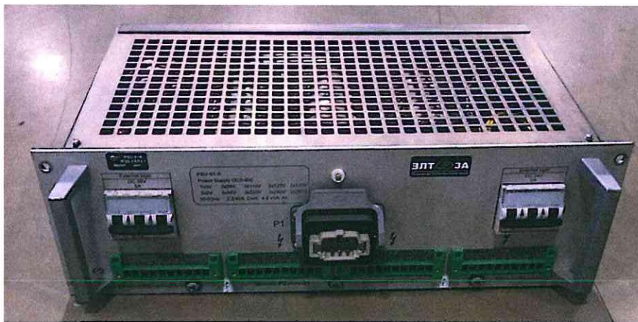
Рисунок 5. Внешний вид источника питания PSU-61 R.
