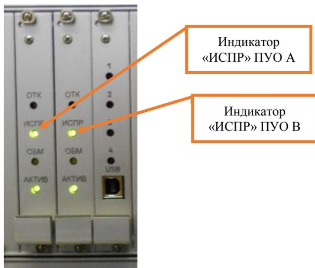
Рисунок 24. Показания индикаторов плат ПУО.
