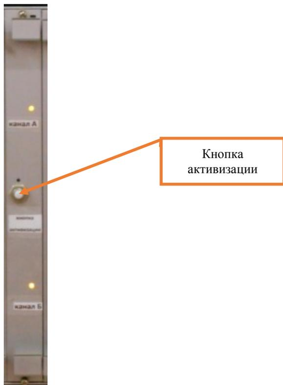
Рисунок 4. Запуск платы ДКБ-Б (ДКБ-Б-2).
