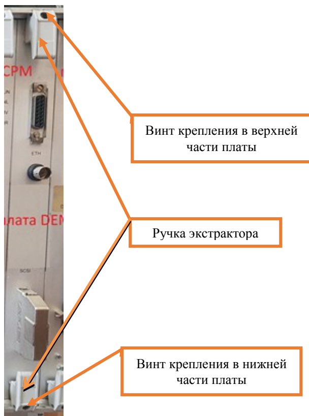
Рисунок 7. Крепление платы DEM.
