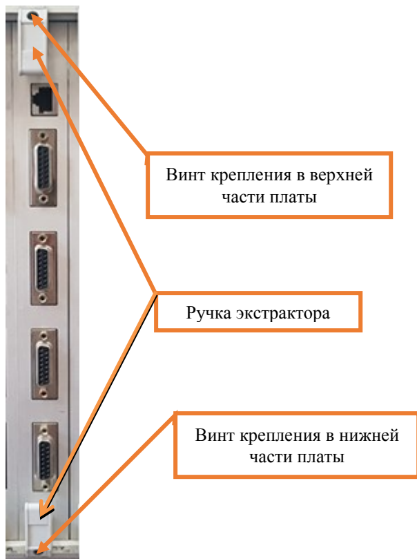
Рисунок 11. Крепление платы ИОМ.
