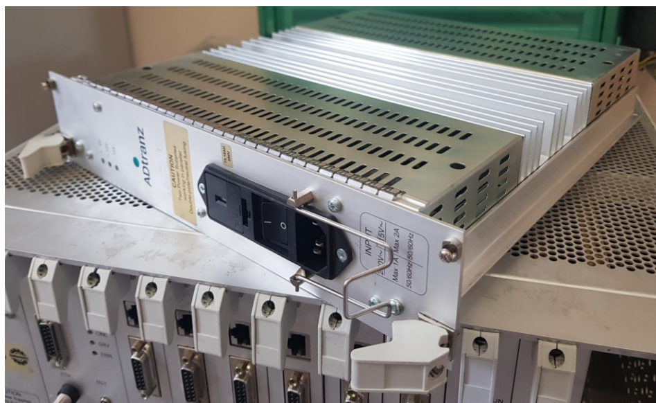
Рисунок 2. Внешний вид платы PSM.
