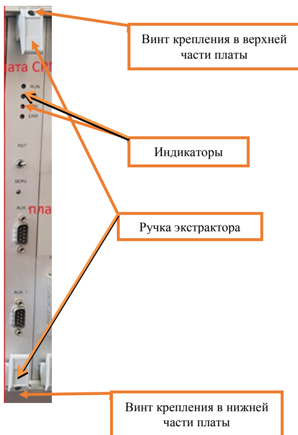
Рисунок 9. Крепление платы СРМ.
