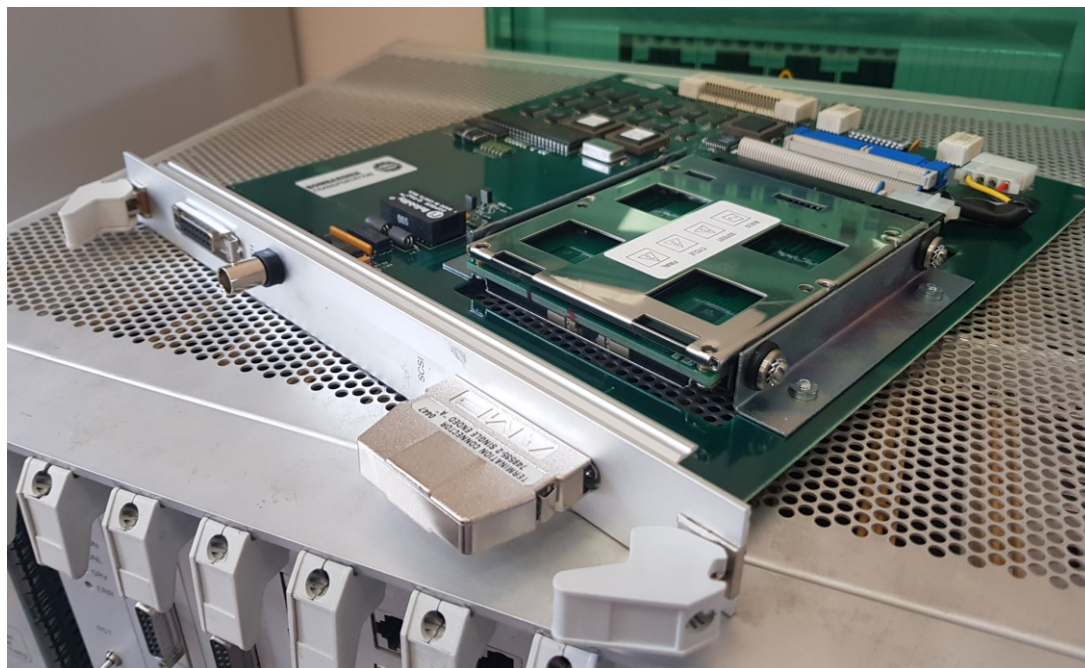
Рисунок 6. Внешний вид платы DEM.
