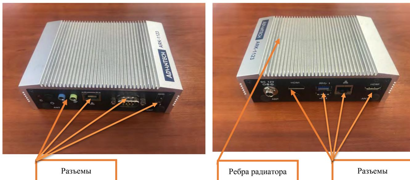
Рисунок 14. Внешняя чистка системного блока ADVANTECH.
